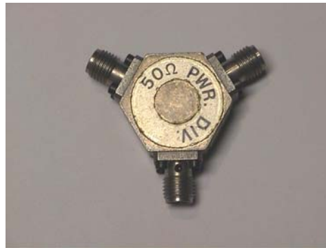
Bild 3: Beispiel eines resistiven Power-Splitters, 0-18 GHz
