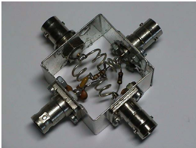
Bild 18: Versuchsaufbau eines Wilkinson-Teilers „1 auf 3“
