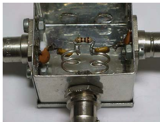
Bild 14: Versuchsaufbau eines 433 MHz-Wilkinson-Teilers mit L-C-Kreisen im Weißblechgehäuse, Abmessungen 37x37x30mm
