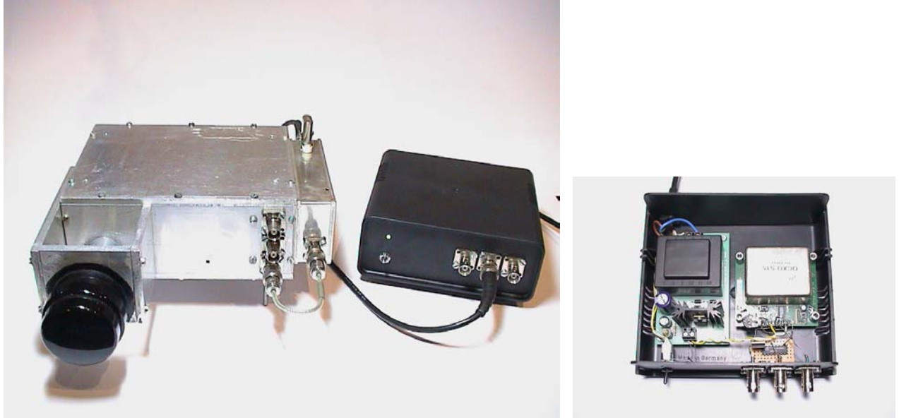
Bild 14: VFO mit seitlich angeflanschter DAFC und externem, optionellen OCXO
