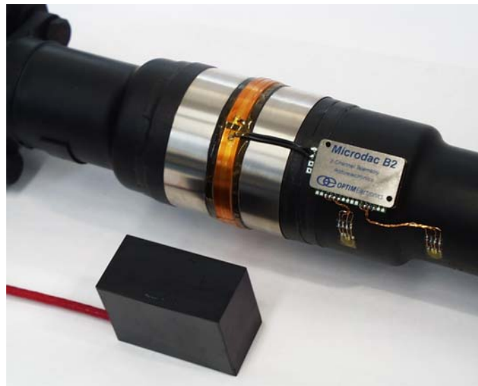
Bild 3: Beispiel für eine 2-Kanal-Telemetrie zur DMS-Messung auf einer Kardanwelle
