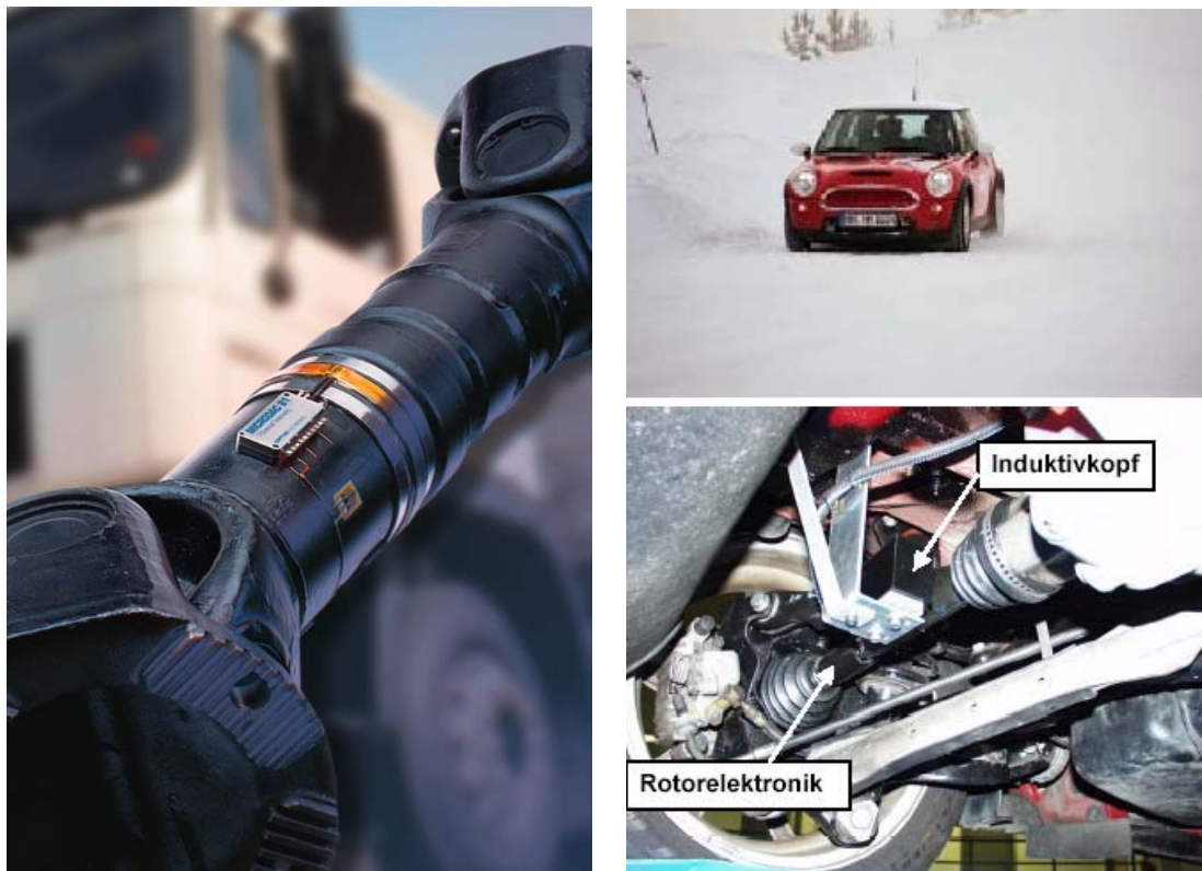
Bild 2: Montage einer 1-Kanal-Telemetrie auf Kardanwelle und Seitenantriebswellen
